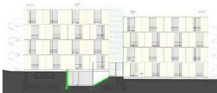
Zwei versetzte Gebäudeteile bilden den Neubau, in den Studenten zum Wintersemester 2011/2012 einziehen können. Der viergeschossige Bau besteht fast komplett aus Holz.
